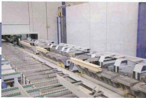
Die patentierten »PowerGrip«-Zangentische gewährleisten eine sichere und präzise Bearbeitung.
