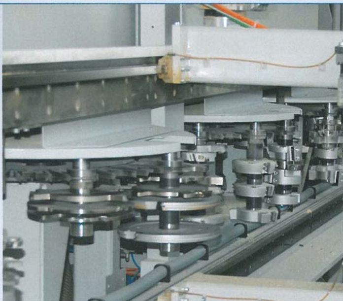
Garant für hohe Flexibilität: Das Werkzeugmagazin ist derzeit auf 30 unterschiedliche Fenstersysteme ausgelegt.
