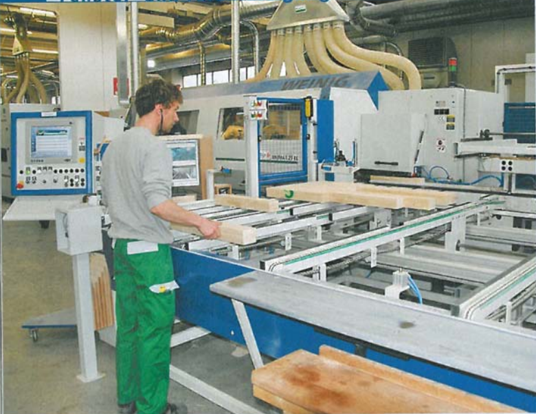
Startpunkt der rahmenweisen Fertigung auf der hoch automatisierten Conturex-Anlage: Videoüberwachung schafft den Überblick.
