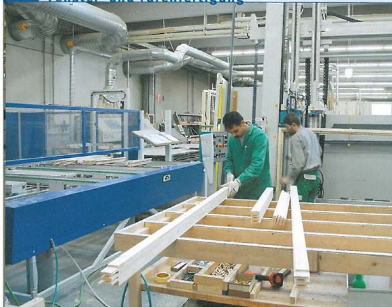
Bearbeitungslängen bis zu 4 m für Fenster und Türen: Die Station Rahmenverleimung ist dem Werkstückauslauf direkt angegliedert.
