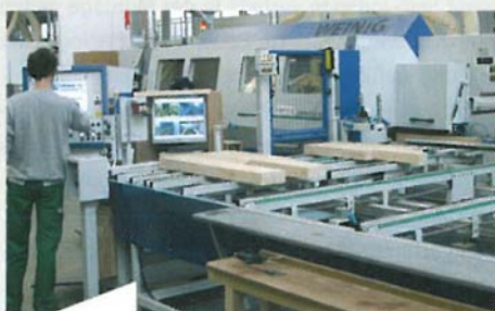
Hier geht es los: Die Kanteln werden der Unimat Hobelmaschine zugeführt.
