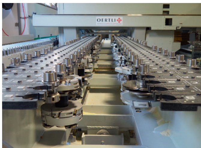
Umfassende Bearbeitung: Im Werkzeugwechsler finden bis zu 248 Fräser oder Bohrer Platz
