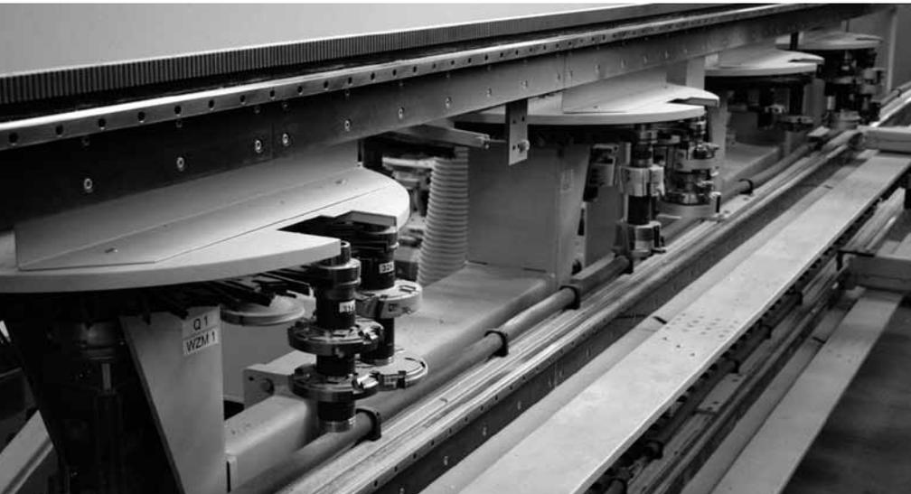
**Fliegender Wechsel:** Um lückenlos produzieren zu können, verfügt die Conturex über ein umfangreiches Werkzeugarsenal
