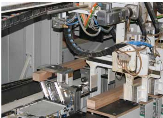
**Fest im Griff:** In der Portalmaschine für die Querbearbeitung werden die Werkstücke von Einzelzangen festgehalten
