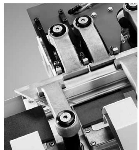
**Versenkbar:** Jede einzelne Zange kann anwendungsbezogen im Maschinentisch versenkt werden
