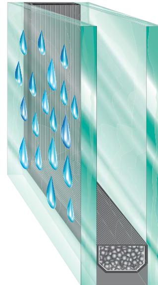
Wird die Taupunkttemperatur der Außenluft unterschritten, fällt Kondensat aus. Eine feuchte Umgebung, z.B. in der Nähe von Gewässern, verstärkt das Problem. In Extremfällen kann das Kondensat auf der Fensteraußenseite sogar anfrieren. Schräg eingebaute Dachflächenfenster sind von dem Effekt stärker betroffen – ähnlich wie beim Pkw Front- und Heckscheibe. Der Effekt lässt sich nur dadurch lindern, dass
