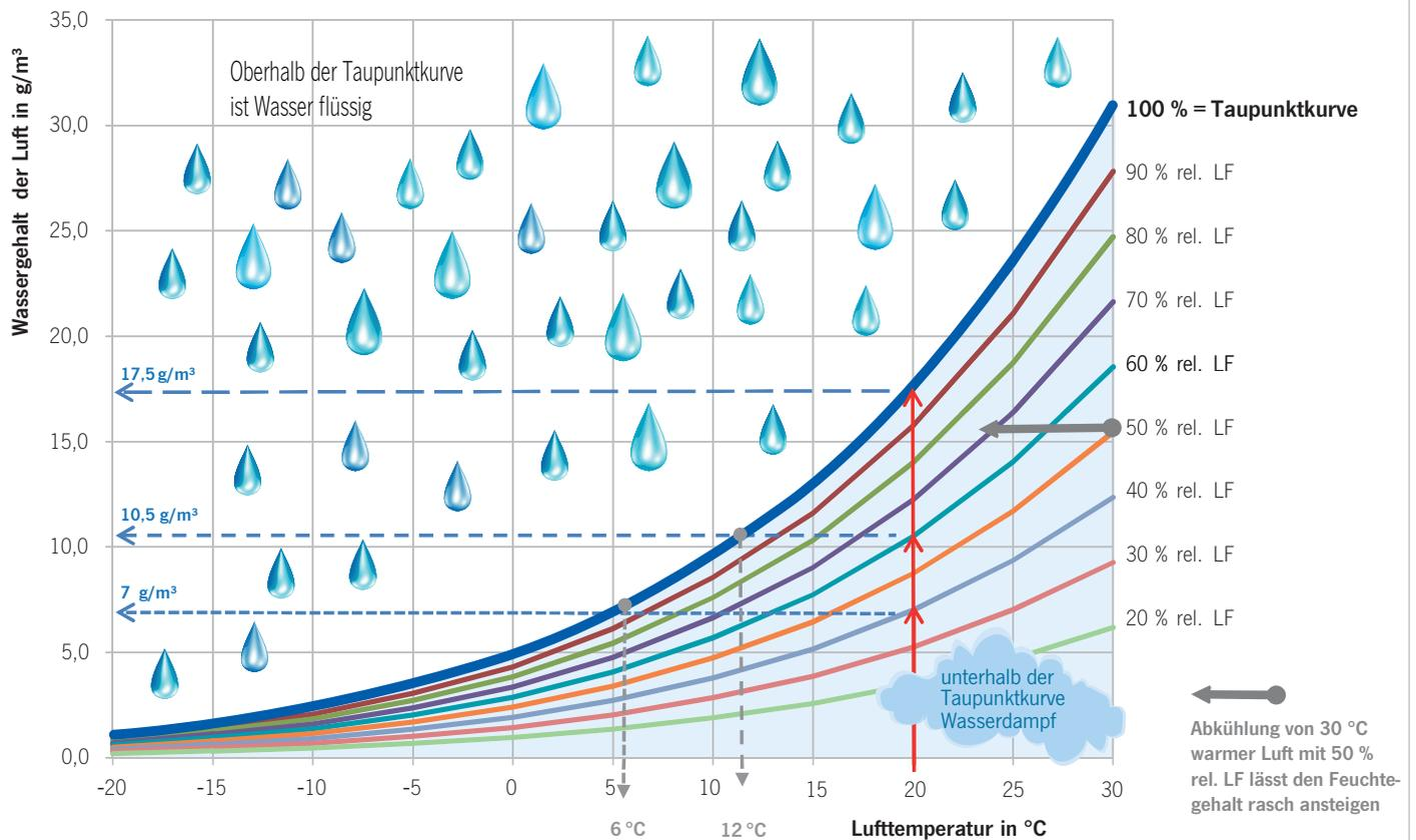
**Abbildung:** Diagramm mit Kurven gleicher relativer Luftfeuchte in Abhängigkeit von der Temperatur. Die Kurve mit 100 % rel. Luftfeuchte wird Taupunkttdiagramm genannt. Sie gibt den Maximalwert von Feuchtigkeit an, welche die Luft bei einer bestimmten Temperatur bis zur Sättigung aufnehmen kann.
