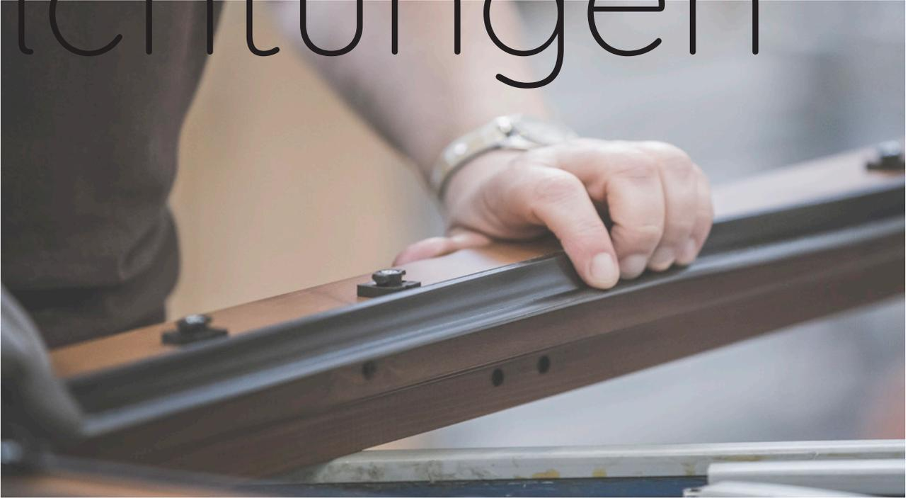
Moderne Falzdichtungen bestehen aus EPDM (Ethylen-Propylen-Dien-Kautschuk). Sie garantieren eine lange Lebensdauer, ein hohes Rückstellungsvermögen und damit eine dauernde Dichtheit des Fensters.
