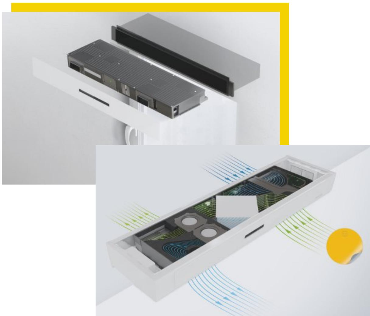
Aircare ES **a doppio flusso** filtra l'aria in entrata ed impedisce l'accesso di inquinanti esterni. **Recupera il calore dell'aria in uscita**. È in grado di estrarre l'aria esausta e rimuove inquinanti interni. Controlla l'umidità e previene alla formazione muffe.
