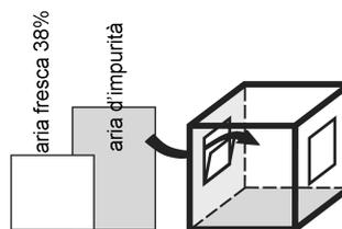
Finestra costantemente aperta tramite ventilazione di spacco o con ferramenta vasistas.
