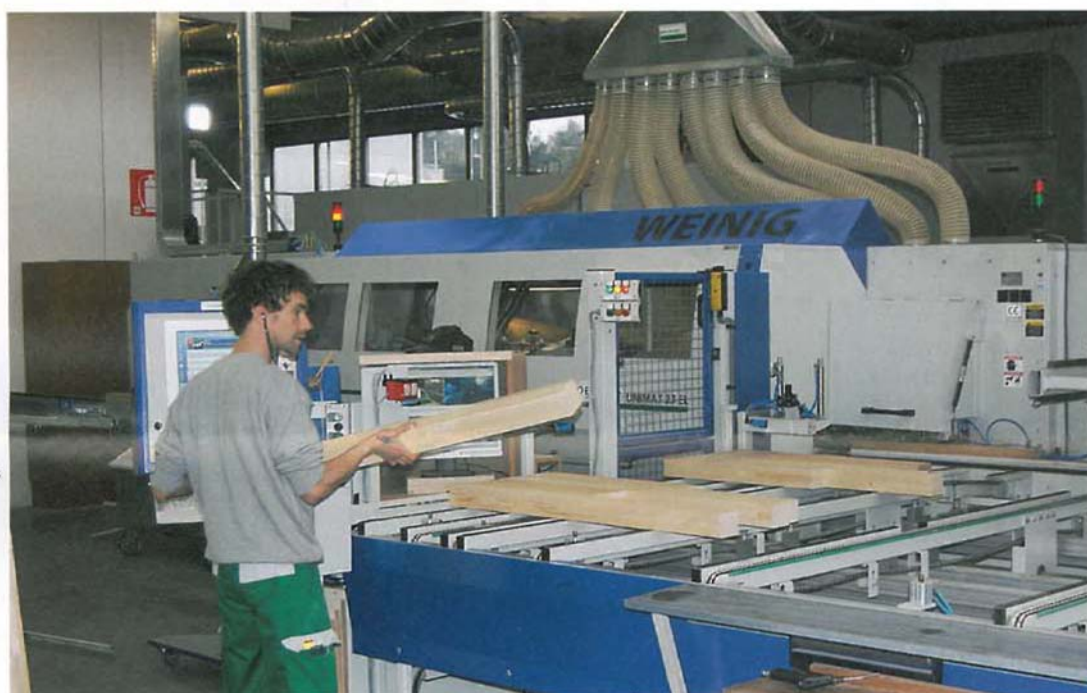
Erste Bearbeitungsstation: Auf dem Weinig Unimat 23 EL wird das Werkstück vierseitig vorgehobelt.
